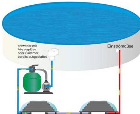
Solarkollektoren werden immer nach der Filteranlage in den Filterkreislauf eingebunden. Damit ist gewährleistet, dass nur gefiltertes Wasser durchläuft und dieser nicht beschädigt wird.
