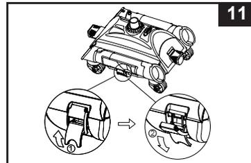
5. Entfernen Sie das Fangnetz (4) vom Reiniger (5). Wenn sich Schmutz im Fangnetz oder Sauger befindet, verwenden Sie den Gartenschlauch zum Reinigen. Siehe Abb. 12.
