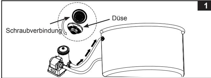
2. Schrauben Sie das Ende des Schlauches A (8) mit dem Anschluss auf das Gewinde der Siebverbindung an der Innenseite des Pools. Siehe Abb. 2.
